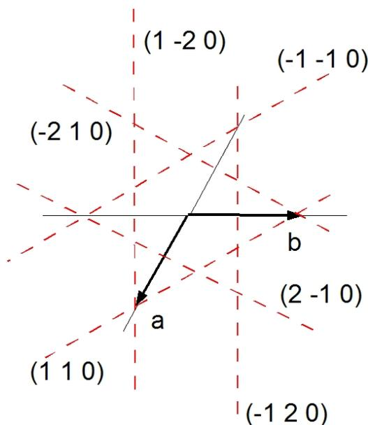
Figure T2\_07 : Trace des plans N°1 de la famille  $(110)$  et de même distance inter réticulaire égale à  $a/2$
