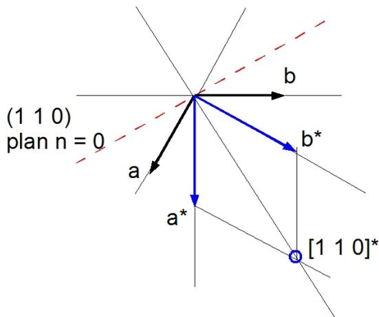
**Figure T2\_13** : réseaux direct et réciproque superposés
