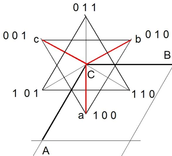
**Figure T2\_18** : Projection de la maille rhomboédrique ( a,b,c ) sur le plan perpendiculaire à l'axe C de la maille hexagonale ( A,B,C) Les coordonnées des nœuds sont rapportées à la maille rhomboédrique.
